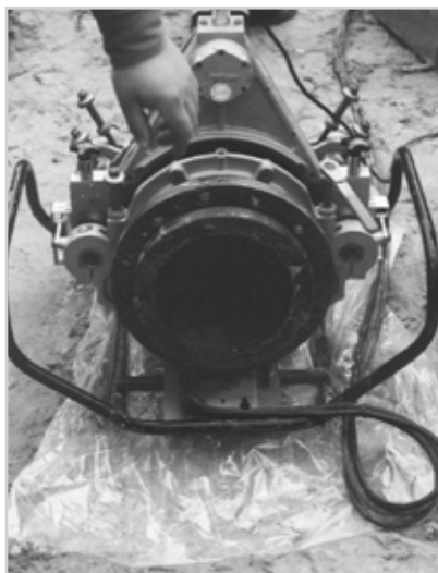
54. ábra: Védelem a hegesztőtűkör kiemelésakor felszálló homokszemcsék ellen fóliaterítéssel
