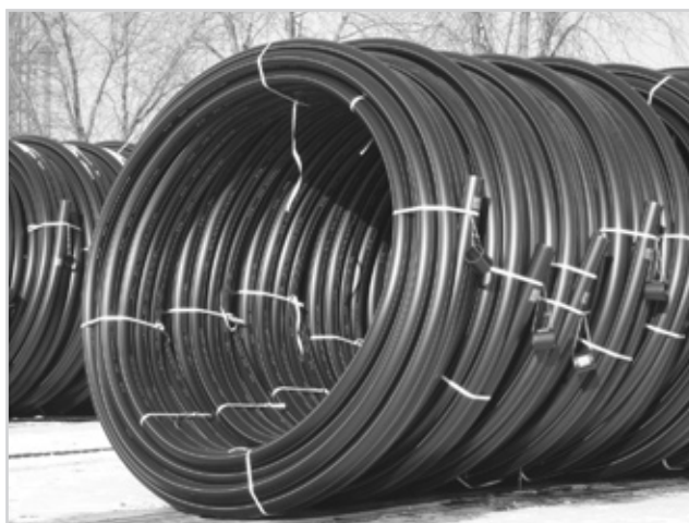
4. ábra: Tekercsben gyártott „csőegységek” szállításra kész állapotban
