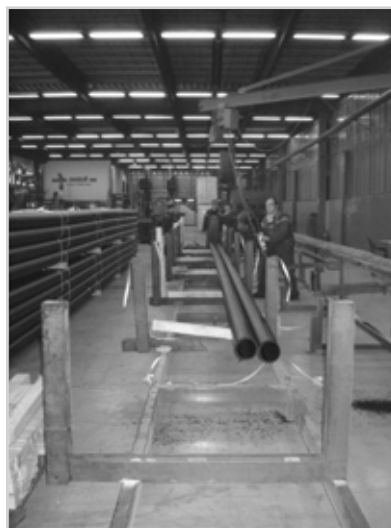
15. ábra: Szálban gyártott csövekből egységgratok készítése a gyártóüzemben
