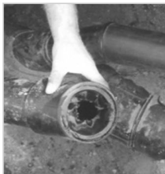
31. ábra: Tokos hegesztés: a technológiából adódó tipikus kötészhiba
