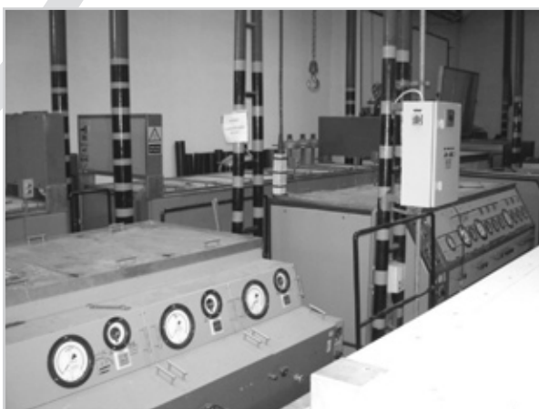
9. ábra: Húzó- és nyomóvizsgálatok elvégzésére alkalmas berendezés, számítógépes vezérléssel és adatrögzítéssel
