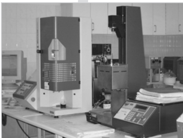
8. ábra: Folyási – MFR – szám vizsgáló készülékek
